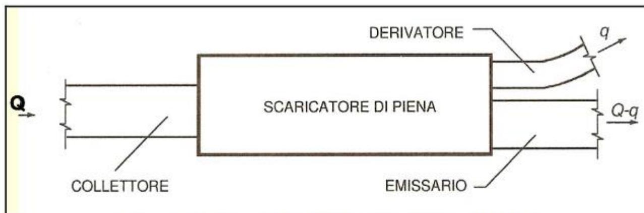
*Figura 1.3: schema di funzionamento di uno scolmatore*
